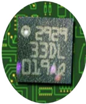
**Figure 1. Accelerometer Sensor**
